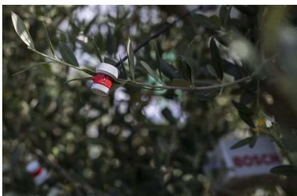
O sistema utiliza pequenos sensores sem fio colocados na folhas das oliveiras e que “medem” o stresse hídrico.
